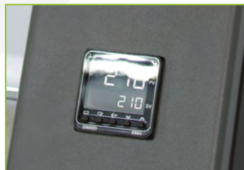
Regulación de temperatura automática
